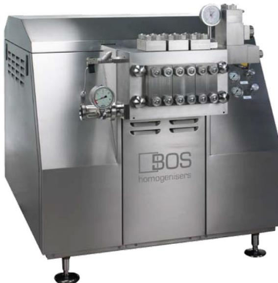
**BLOC EFFET :** Un ou deux effets, selon service. Blocs en acier inoxydable forgé. Premier effet généralement équipé d'un siège stellite avec clapet type cigare en stellite et protégé par un anneau de choc. Deuxième effet généralement équipé d'un siège stellite avec clapet type champignon. Réglage de la pression de travail soit manuellement par manivelle soit par tiroir hydraulique. Refoulement au choix.
